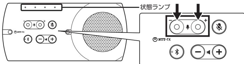
マイク音量を調整します。大きくするときは“+”小さくするときは“-”を押します。また、調整した音量は、状態ランプで約2秒間表示をします。
