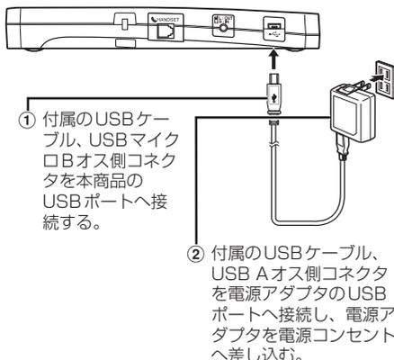
① 付属のUSBケーブル、USBマイクロBオス側コネクタを本商品のUSBポートへ接続する。
