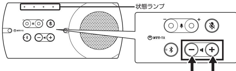
スピーカー音量を調整します。大きくするときは“+”小さくするときは“-”を押します。また、調整した音量は、状態ランプで約2秒間表示をします。
