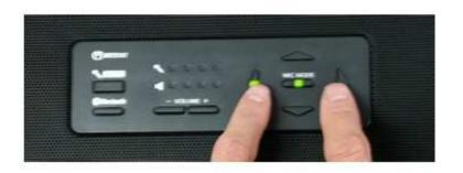
①エリア集音ボタンの左右を同時に押し、「マイクボリューム 変更モード」にします。
